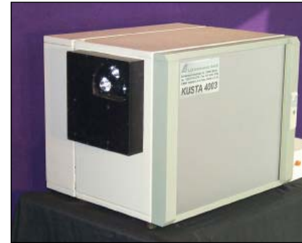
Bild 3 Fotografie des NIR-Spektrometers zur Messung schwarzer Kunststoffe
