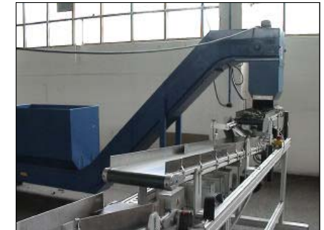
Bild 5 Sortieranlage für geshredderte Kunststoffteile
