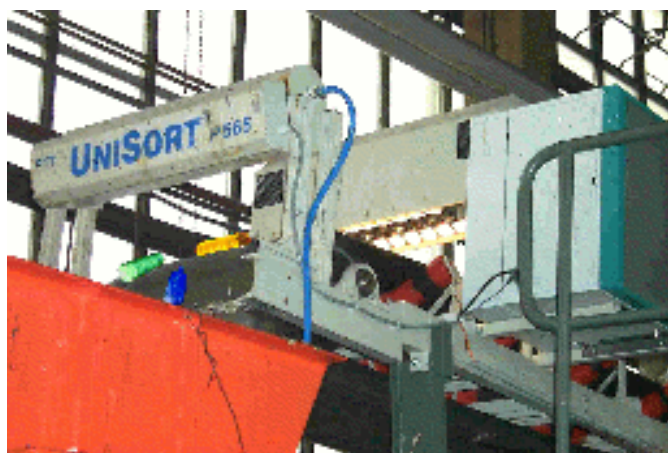
Abb. 4 Anlage Unisort zur sortenreinen Trennung von Kunststoffen aus dem Hausmüll
